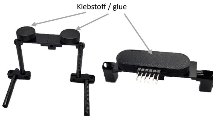
An den gekennzeichneten Stellen Klebstoff auftragen und die Karosserie aufsetzen und ausrichten. Dann denn Klebstoff nach Datenblattangaben aushärten lassen.
