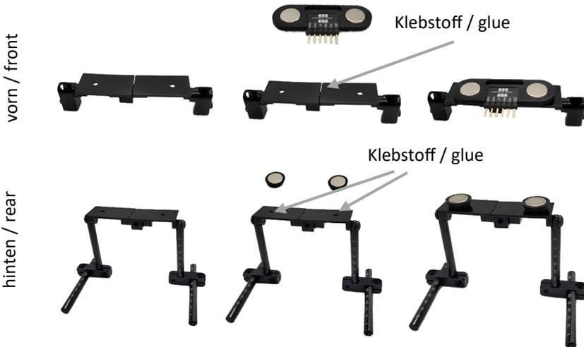
Klebstoff wie gekennzeichnet auftragen und die Halterung mittig bzw. symmetrisch ankleben. Den Klebstoff nach Datenblatt aushärten lassen.
